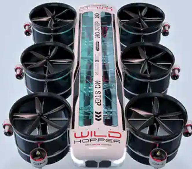
La start-up espagnole Drone Hopper a développé un engin volant qui peut transporter jusqu'à 600 litres d'eau.
